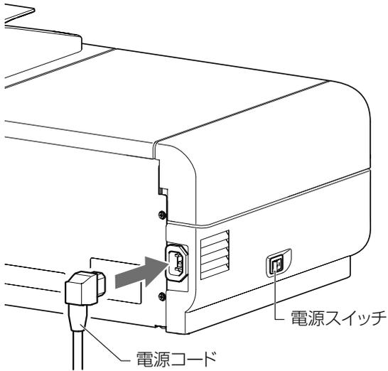
電源コードのプラグをコンセントに差し込みます。
